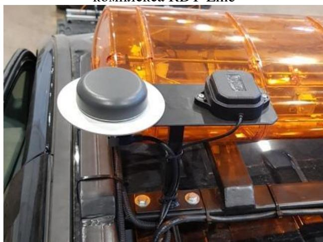
Рисунок 4 – Приёмные антенны аппаратуры геодезической спутниковой NV08C-RTK-M канала «координаты»
