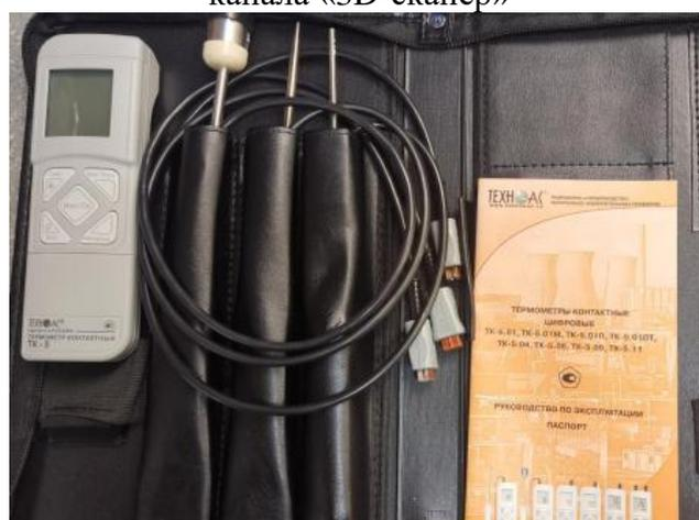
Рисунок 13 – Термометр контактный цифровой ТК-5.06 канала «температура»
