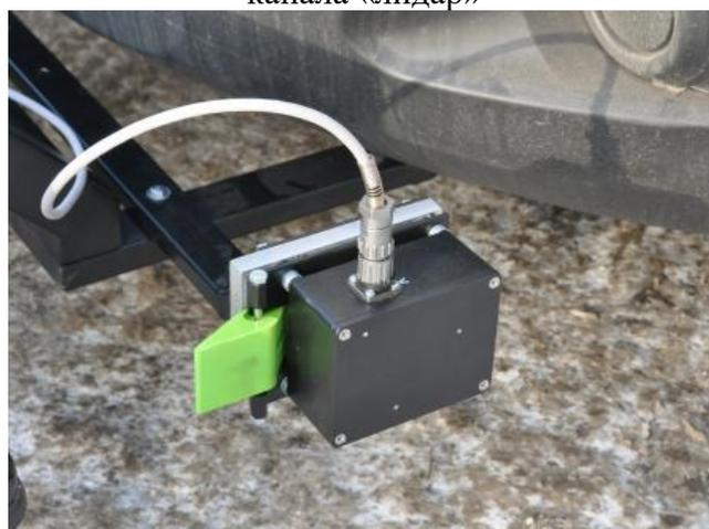
Рисунок 7 – Профилометр дорожный РДТ-818 канала «макросероховатость»
