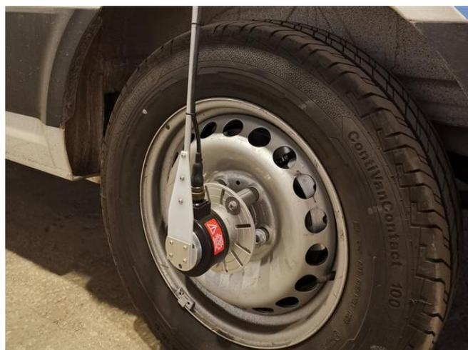
Рисунок 3 – Датчик пройденного пути РДТ-819 канала «путь В»
