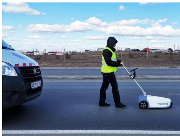
Рисунок 9 – Профилометр ручной РДТ-125 канала «ровность IRI»
