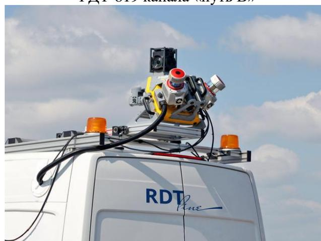
Рисунок 5 – Система мобильного картографирования Trimble MX9 канала «лидар»
