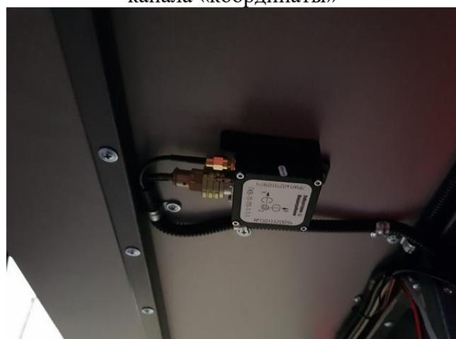
Рисунок 6 – Инерциальная навигационная система РДТ-816 канала «геометрия В»
