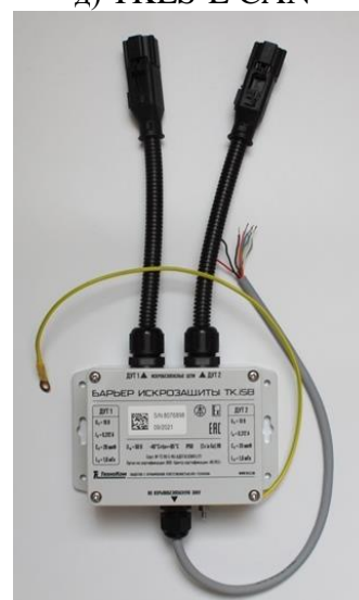
е) TKLS во взрывозащищенном исполнении с барьером искрозащиты ТК.iSB
