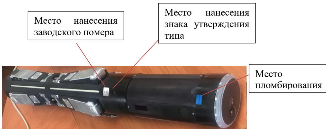
Рисунок 3 - Места нанесения маркировки прибора модификации 112/190
