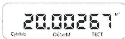
Рисунок 3 – Жидкокристаллический дисплей в режиме «Поверка»
