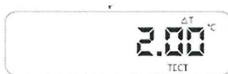
Рисунок 4 – Жидкокристаллический дисплей, отображающий разность температур
