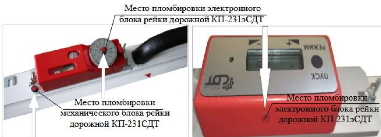
Рисунок 4 – Внешний вид механического блока рейки дорожной КП-231СДТ
