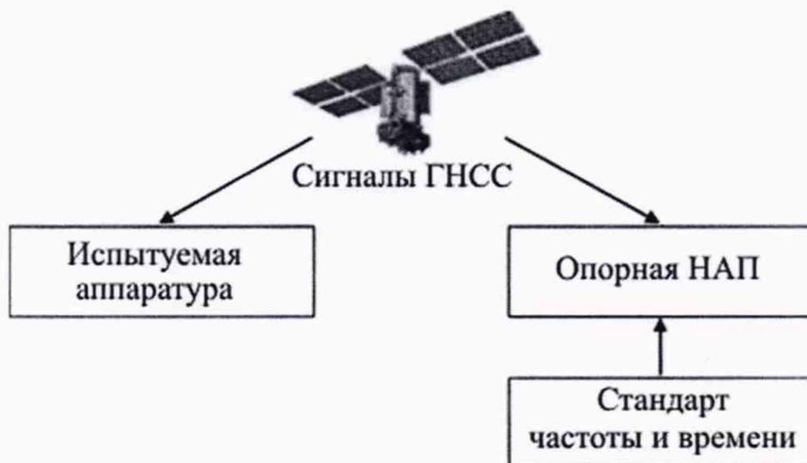
Рисунок 1 — Структурная схема проведения измерений
