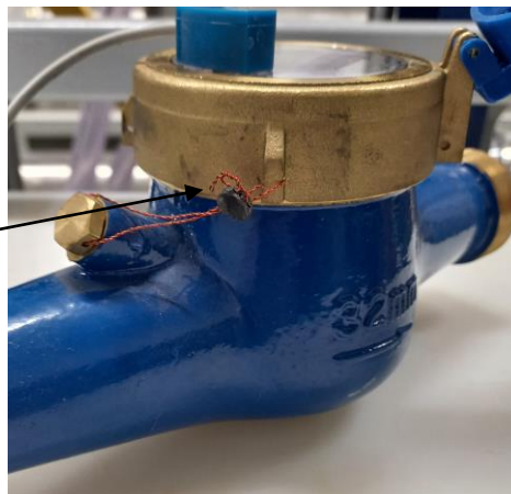
Рисунок 2 – Место нанесения знака поверки на счётчики холодной и горячей воды крыльчатые многоструйные МВС
