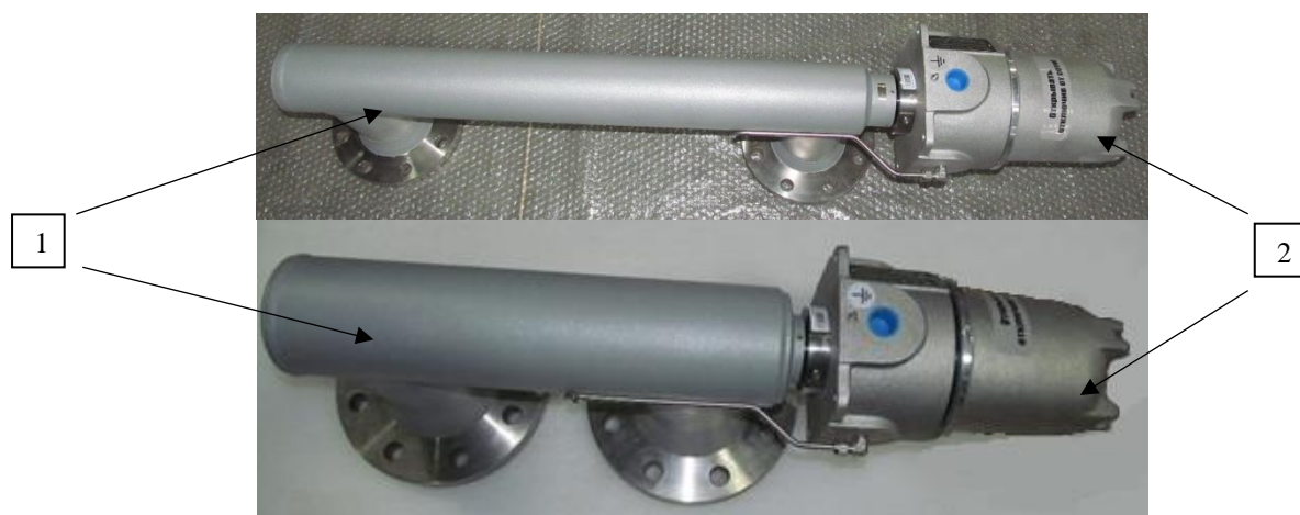
Рисунок 1 – Общий вид влагомеров при байпасном способе монтажа 1 – первичный преобразователь, 2 – электронный блок
