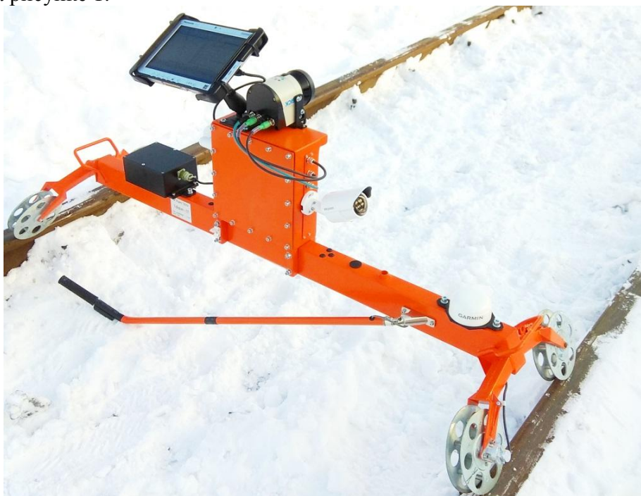
Рисунок 1 – Общий вид комплексов автоматизированного контроля приближения строений «Габарит-С»
