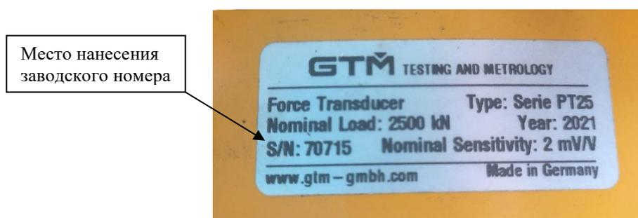
Рисунок 2 – Внешний вид маркировочной таблички
