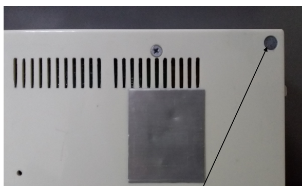
Место пломбировки панельного компьютера
