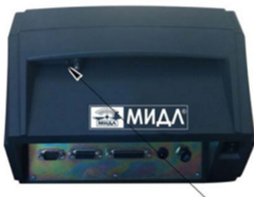
Пломба с оттиском поверительного клейма
