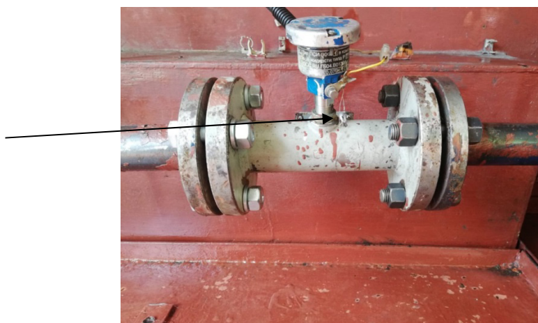
Рисунок 3 – Схема пломбировки от несанкционированного доступа и обозначение места нанесения знака поверки установки поверочной передвижной КиПР зав. № 01
