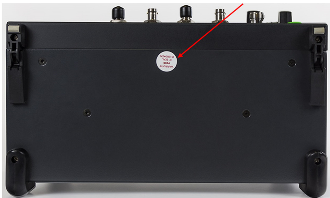
Рисунок 2 – Место нанесения серийного номера, идентифицирующего каждый экземпляр СИ (вид сзади)
