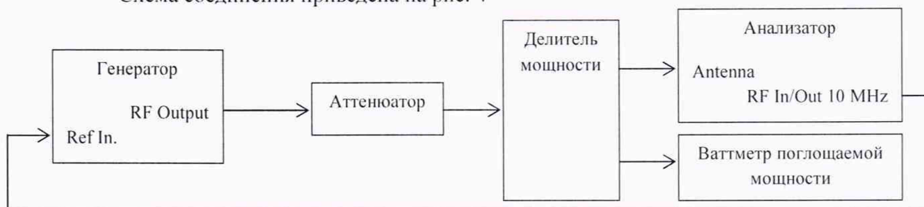
Рисунок 4 – Схема соединения приборов для определения абсолютной погрешности измерений уровня мощности сигнала на входе «Antenna»
