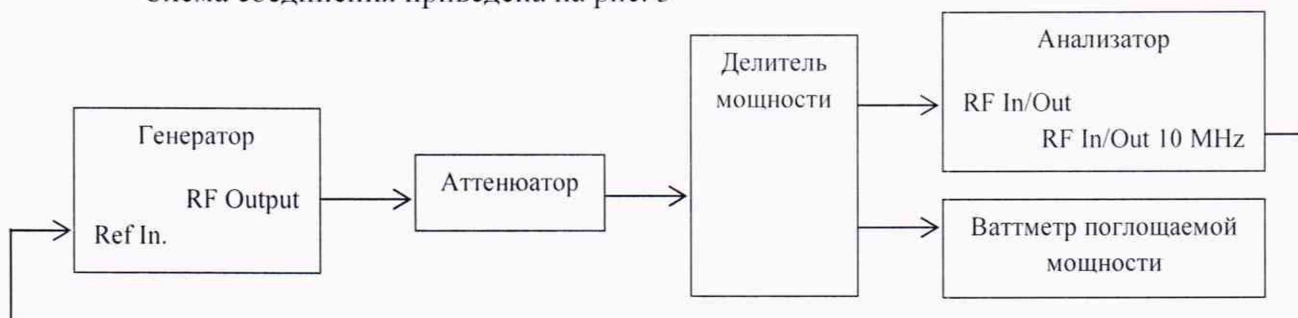
Рисунок 3 – Схема соединения приборов для измерения абсолютной погрешности измерения уровня мощности сигнала на входе «RF In/Out»
