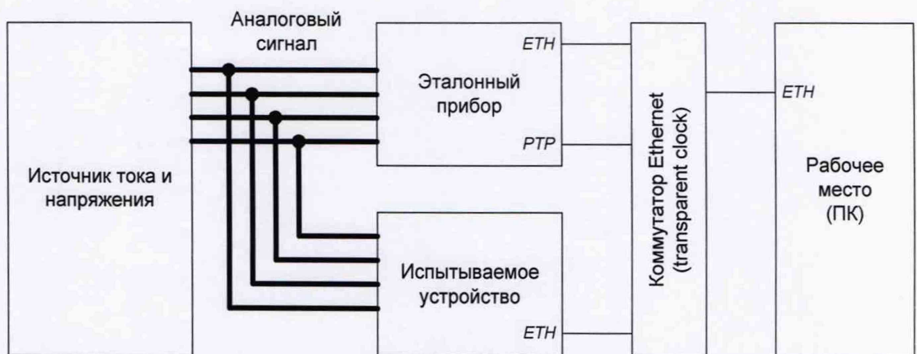
Рисунок 5 – Схема стенда для испытаний метрологических характеристик модуля измерения напряжения релейной защиты и автоматики в части каналов измерения напряжения общего назначения
