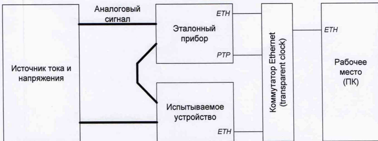
Рисунок 3 – Схема стенда для испытаний метрологических характеристик модуля измерения тока для целей релейной защиты и автоматики (для испытаний в точках 0,2 \cdot I_{ном} и 2 \cdot I_{ном} )
