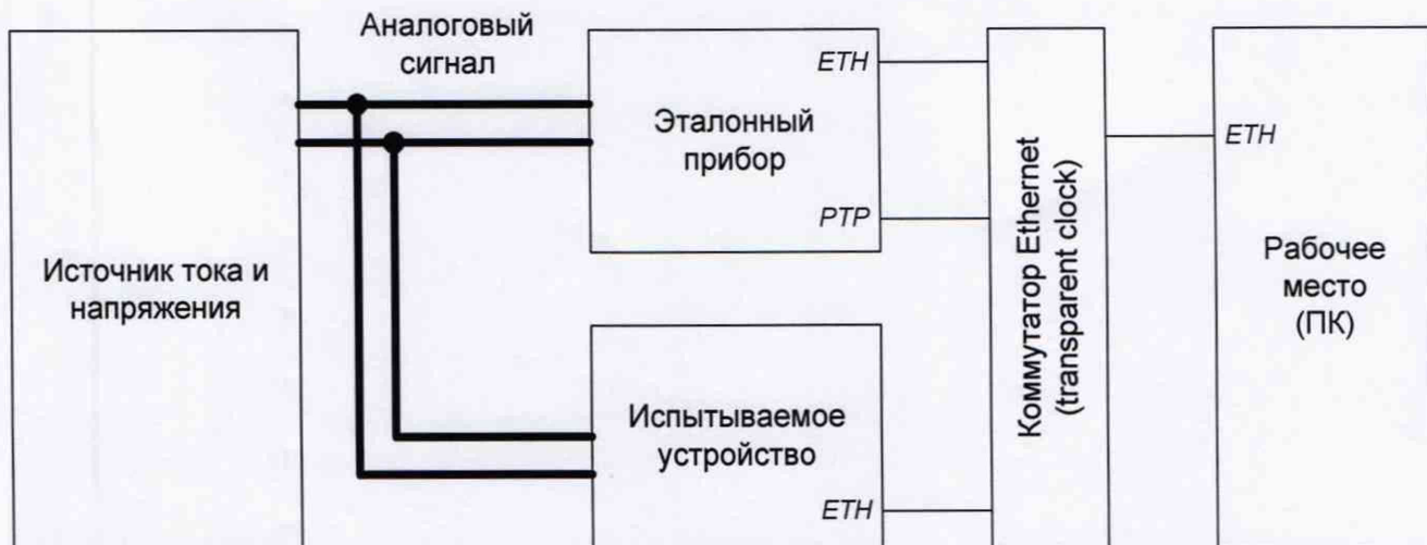
Рисунок 6 – Схема стенда для испытаний метрологических характеристик модуля измерения напряжения релейной защиты и автоматики (VT-P) в части каналов для измерительных цепей отбора напряжения
