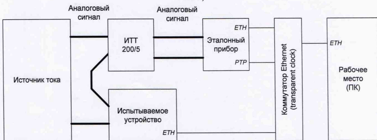
Рисунок 3 – Схема стенда для испытаний метрологических характеристик модуля измерения тока для целей релейной защиты и автоматики (для испытаний в точках 0,2 \cdot I_{ном} и 2 \cdot I_{ном} )
