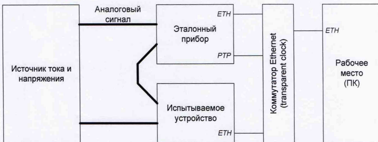
Рисунок 1 – Схема стенда для испытаний метрологических характеристик модуля измерения тока
