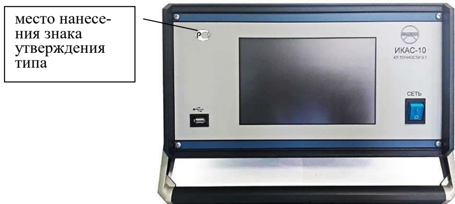
Рисунок 1 – Общий вид измерителей электрического сопротивления постоянному току ИКАС-10
