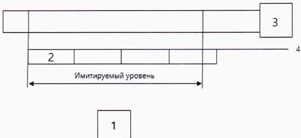
Рисунок Б.1 – Схема проверки с помощью блоков свинцовых на месте эксплуатации
