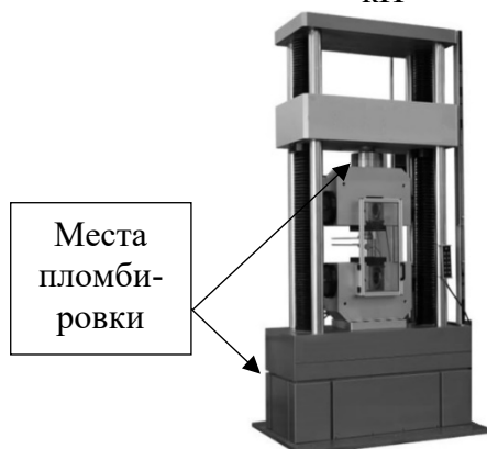
Рисунок 5 - Общий вид машин испытательных универсальных SUBRAMAX PM BC-XXX-D-E-F-II с верхним пределом измерений 1000 кН
