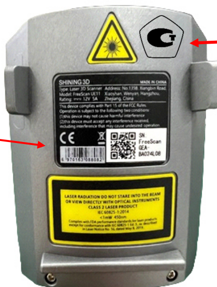
Рисунок 3 - Место расположения маркировочной наклейки с указанием заводского (серийного) номера прибора и место нанесения знака утверждения типа.
