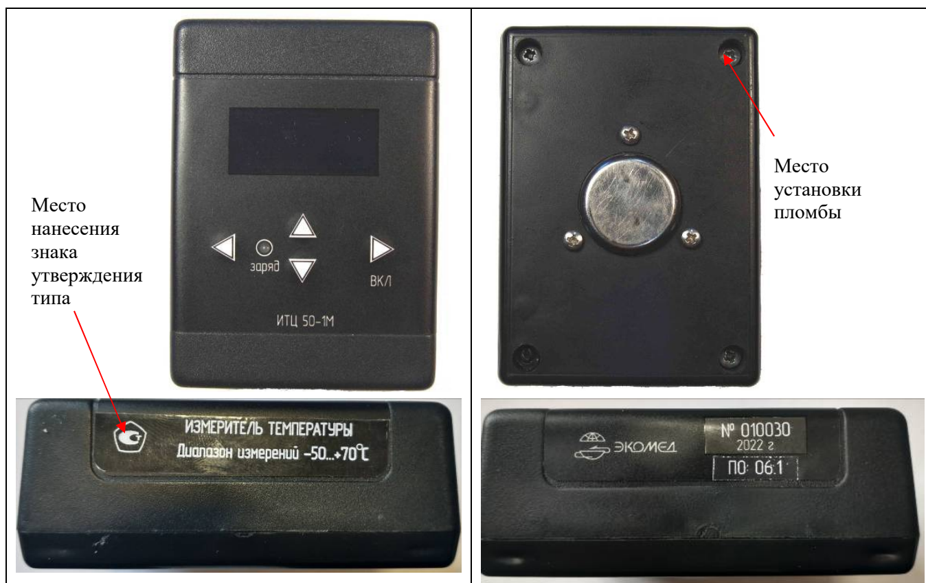
Рисунок 1 - Общий вид Измерителя, схема пломбировки корпуса от несанкционированного доступа и место нанесения знака утверждения типа на боковой поверхности
