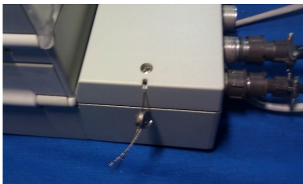
2.1 Пломбирование блока контроллера анализатора
