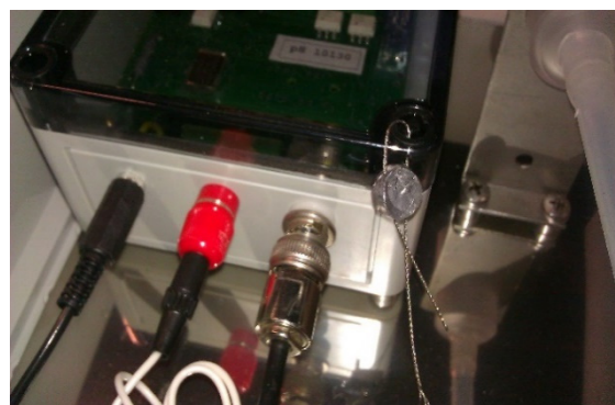
2.2 Пломбирование выносного модуля анализатора
