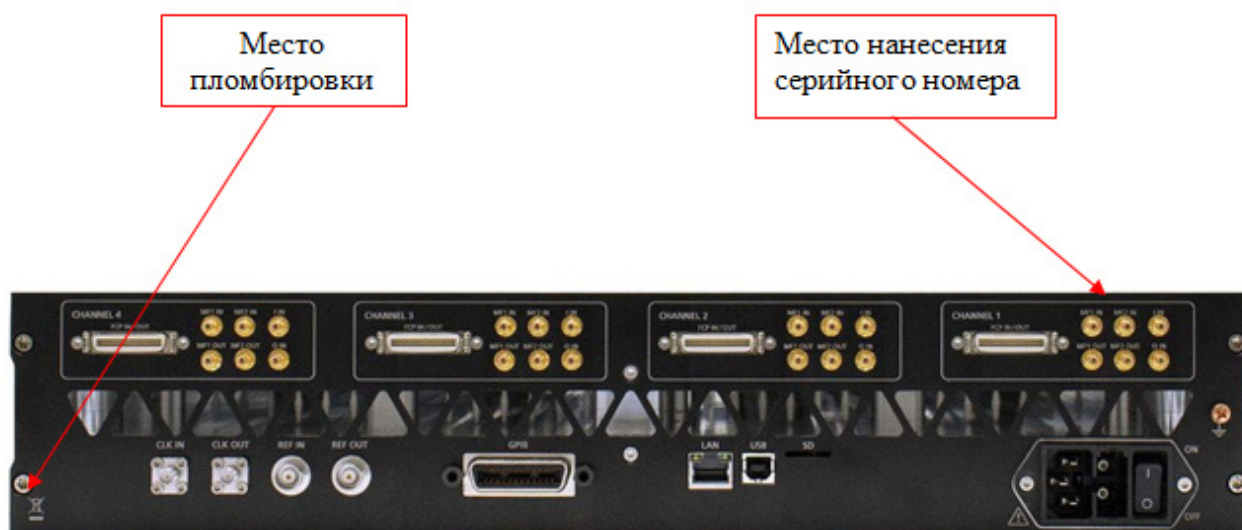
Рисунок 4- Схема пломбировки от несанкционированного доступа и место нанесения серийного номера, идентифицирующего каждый экземпляр СИ (модификации RFVSG4-X, RFVSG6-X, RFVSG12-X, RFVSG20-X, RFVSG40-X)
