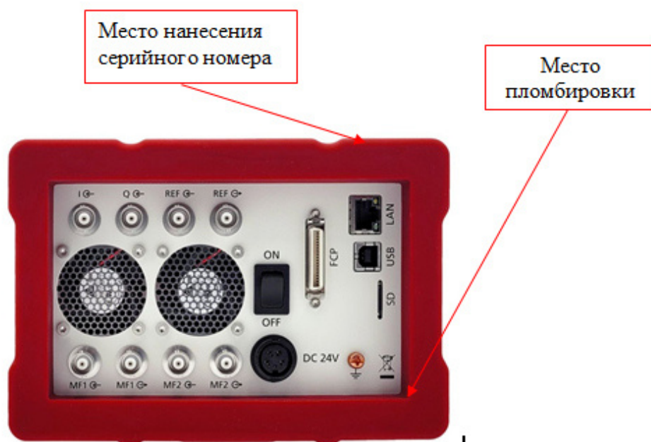
Рисунок 3- Схема пломбировки от несанкционированного доступа и место нанесения серийного номера, идентифицирующего каждый экземпляр СИ (модификации RFVSG4, RFVSG6, RFVSG12 RFVSG20, RFVSG40)
