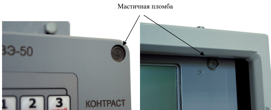
Рисунок 3 – Схема пломбировки прибора ИВЭ-50 от несанкционированного доступа
