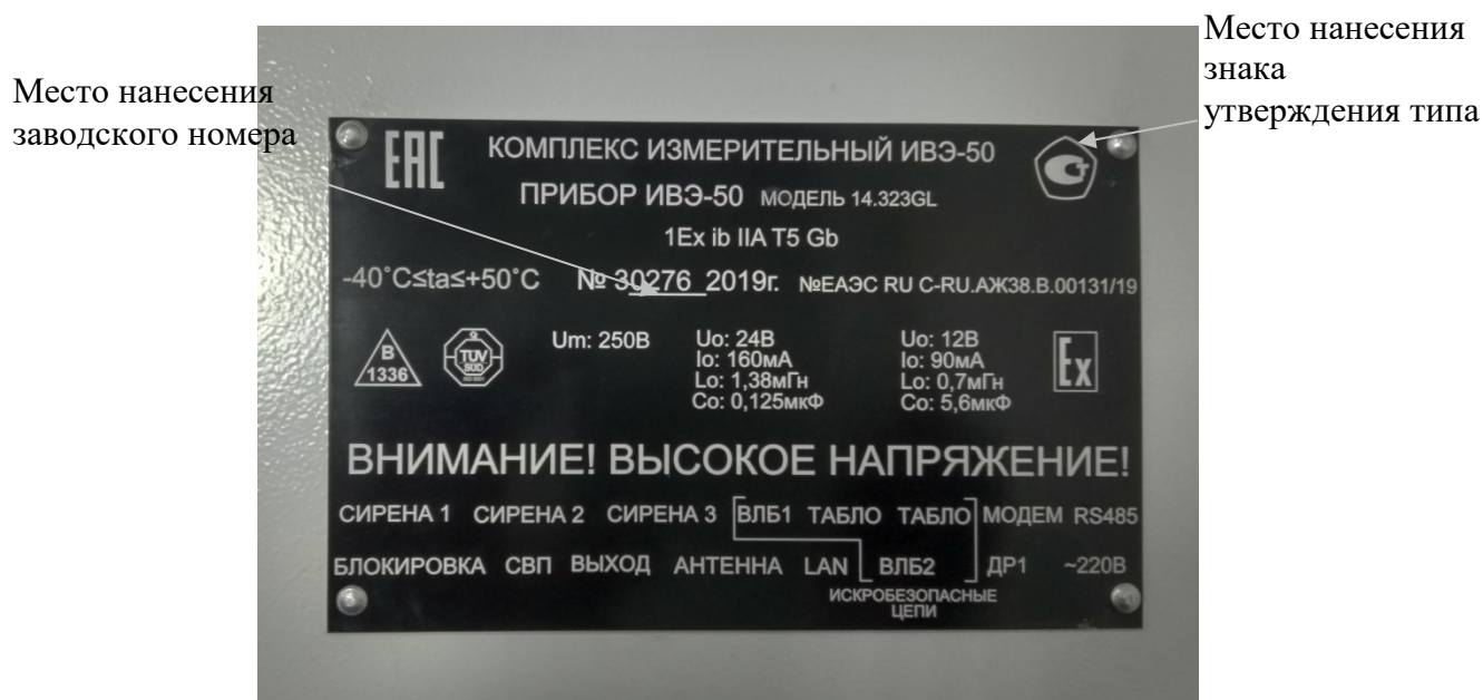
Рисунок 5 – Внешний вид шильдика на приборе ИВЭ-50
