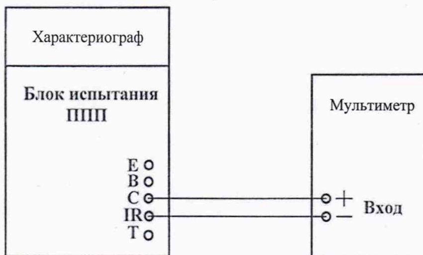
Рисунок 5 – Схема подключения для определения абсолютной погрешности измерений силы начального и обратного тока исследуемого ППП
