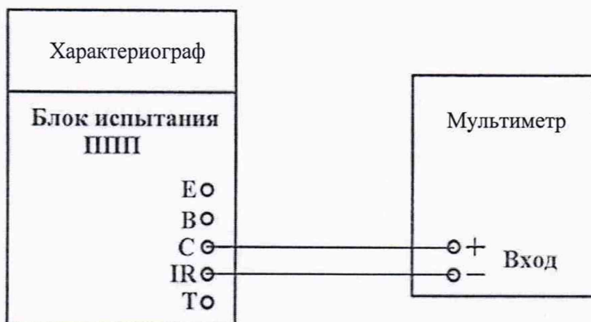
Рисунок 1 – Схема подключения для определения абсолютной погрешности измерений напряжения на коллекторе (или аналогичном ему электроде) исследуемого полупроводникового прибора
