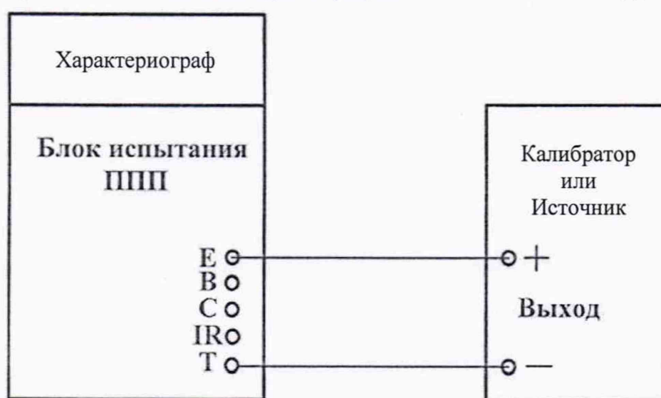
Рисунок 4 – Схема подключения для определения абсолютной погрешности силы тока в цепи коллектора исследуемого ППП
