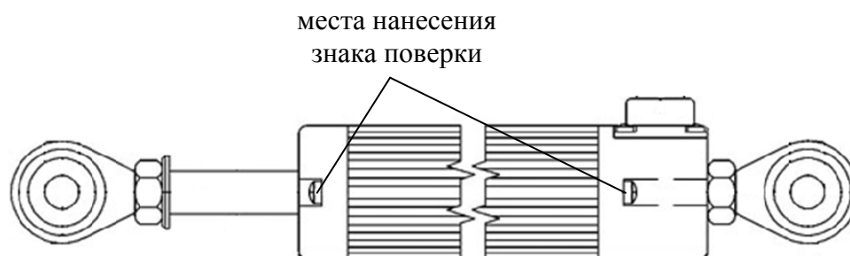
Рисунок 2 – Схема пломбировки от несанкционированного доступа, обозначение места нанесения знака поверки для датчиков модификаций RC35-175-K-R5K и RC35-450-K-R5K
