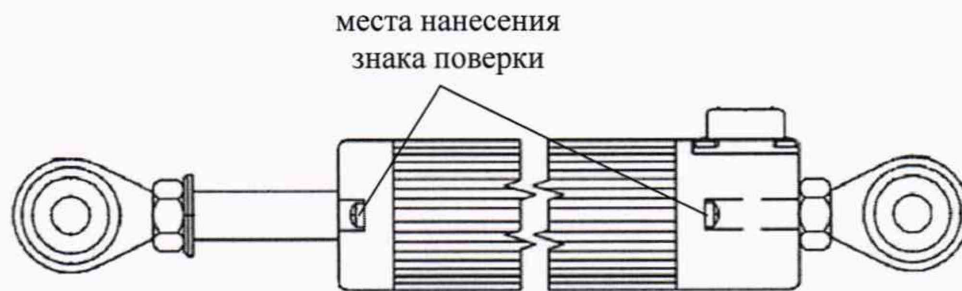
Рисунок 4 – Обозначение мест нанесения знака поверки для датчиков модификаций RC35-175-K-R5K и RC35-450-K-R5K
