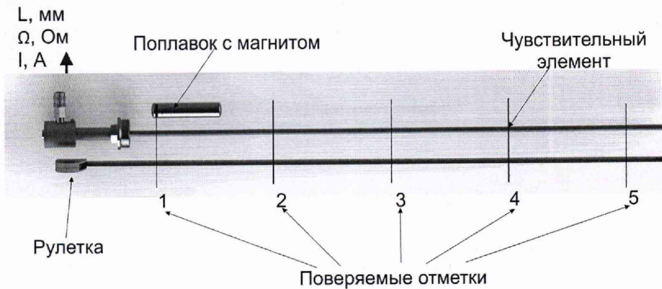
Рисунок 3 – Проверка датчика уровня с помощью рулетки и магнитного поплавка
