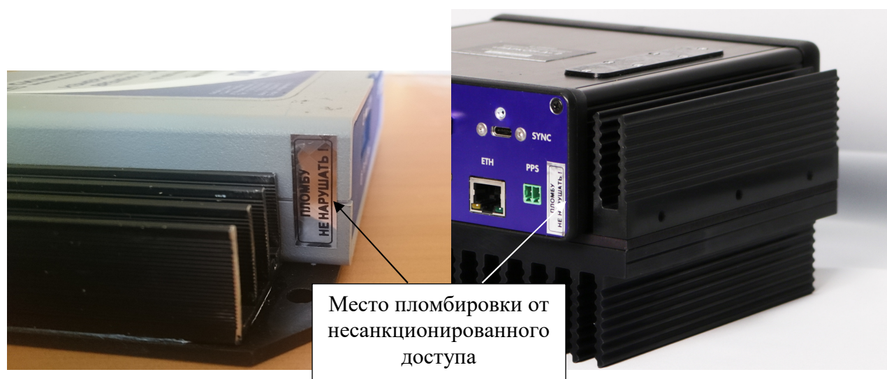
Рисунок 1 - Общий вид измерителей, места размещения знака утверждения типа и заводского номера
