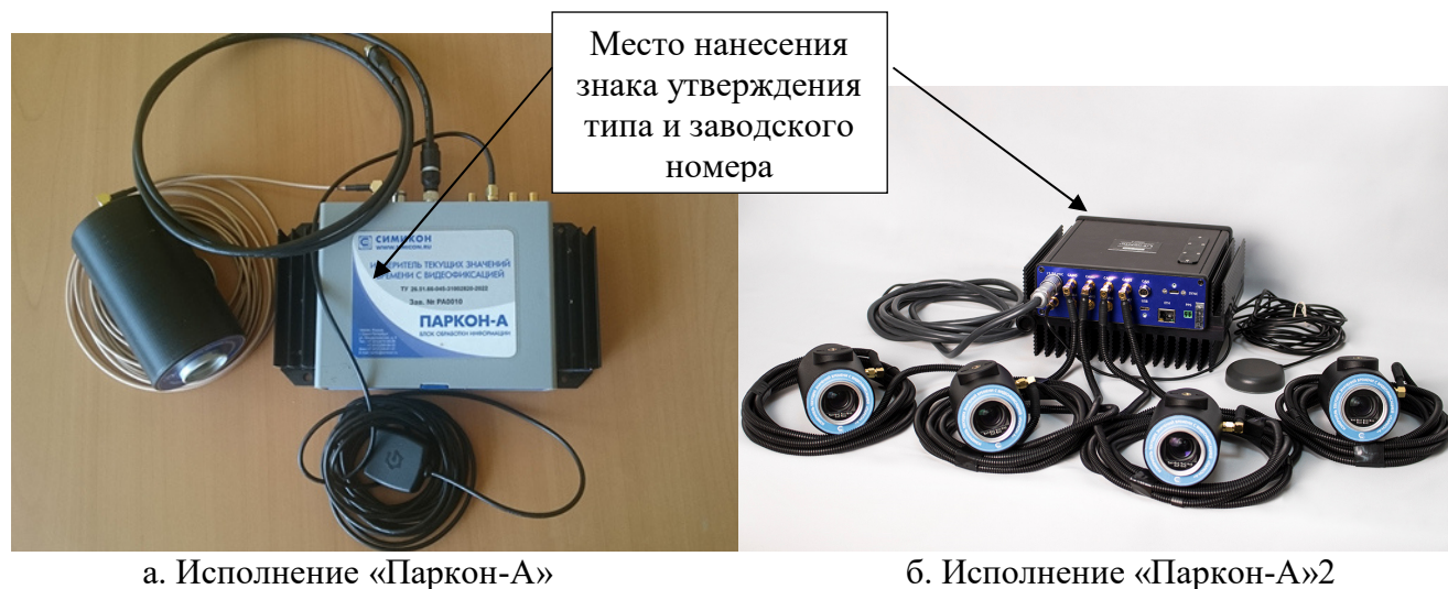
Рисунок 1 - Общий вид измерителей, места размещения знака утверждения типа и заводского номера
