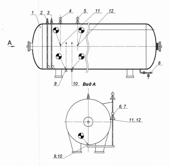
1 – резервуар; 2, 3 – приемные патрубки; 4,5 – уровнемеры 75LT0003A, 75LT0003B; 6,7 – уровнемеры 75LT0004A, 75LT0004B, 8 – пробоотборный кран;. 9 – патрубок уровнемера 75LT0004A; 10 – патрубок уровнемера 75LT0004B; 11 – патрубок уровнемера 75LT0003A; 12 – патрубок уровнемера 75LT0003B
