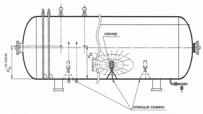
$H_{yp}^{75LT0003A}$  – высота установки патрубка уровнемера 75LT0003A;  $H_{yp}^{75LT0003B}$  – высота установки патрубка уровнемера 75LT0003B
