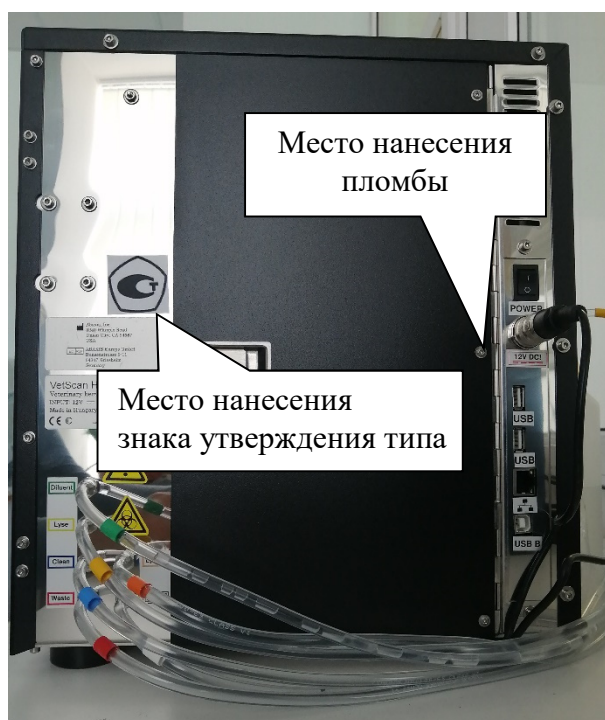
Рисунок 2 - Схема пломбировки от несанкционированного доступа, место, способ и формат нанесения заводских номеров и знака утверждения типа.
