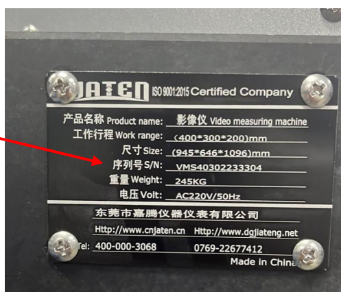
Рисунок 2 - Место расположения маркировочной таблички с указанием заводского номера прибора
