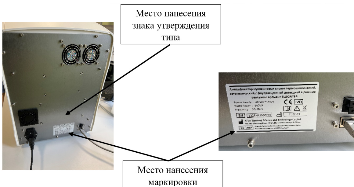
Рисунок 2 – Общий вид и схема маркировки амплификаторов
