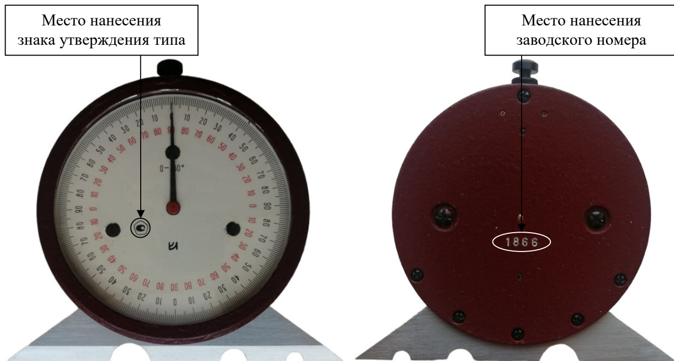
Р и с у н о к 1 – Общий вид угломеров ЗУРИ-М с указанием мест нанесения заводского номера и знака утверждения типа
