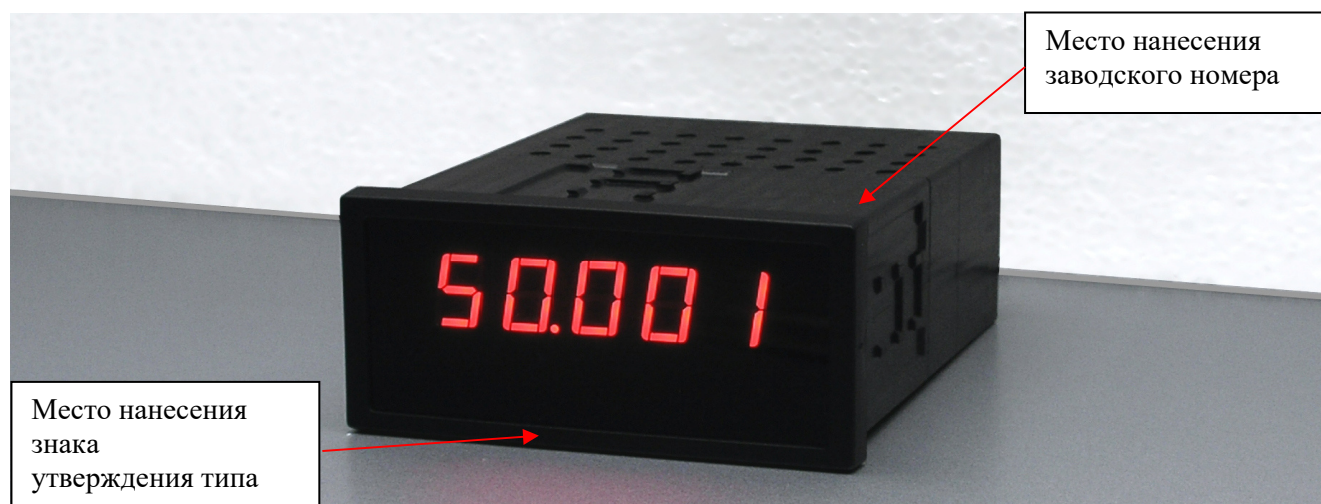
Рисунок 1 - Общий вид измерителей частоты промышленной сети ИЧС5-14
