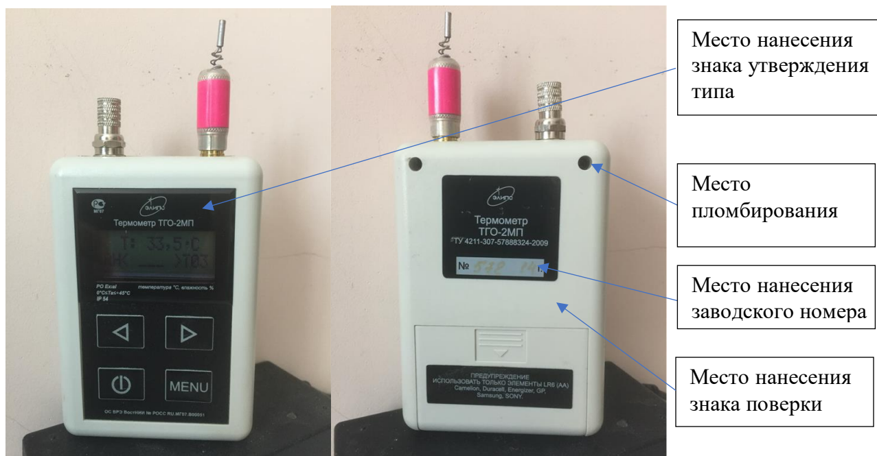
Рисунок 1. Общий вид термометра электронного ТГО-2МП, обозначение мест нанесения знака утверждения типа, знака поверки и место пломбирования
