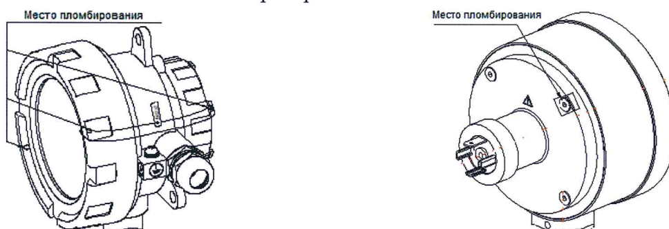
Рисунок 5 – Схема пломбировки ЭКМ от несанкционированного доступа
