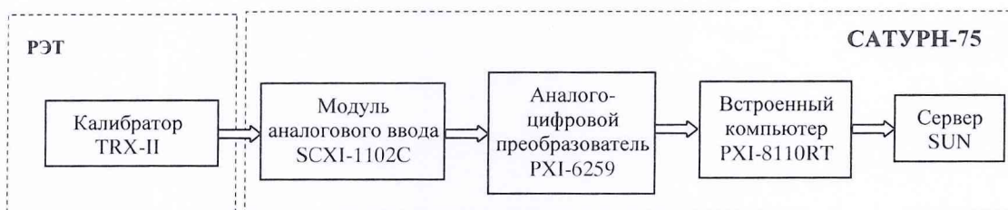
Рисунок 5 – Схема поверки ИК силы постоянного тока рабочим эталоном TRX-II
