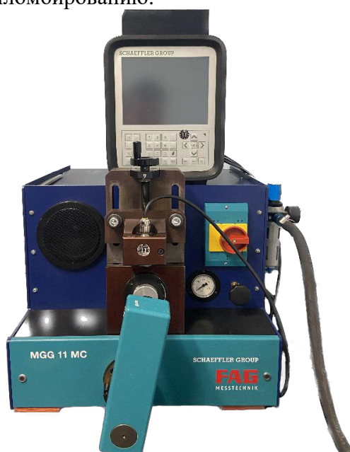
Рисунок 1 - Общий вид стенда вибродиагностики прецизионных подшипников MGG11-MC500 с включенным в него ИВК MC500
