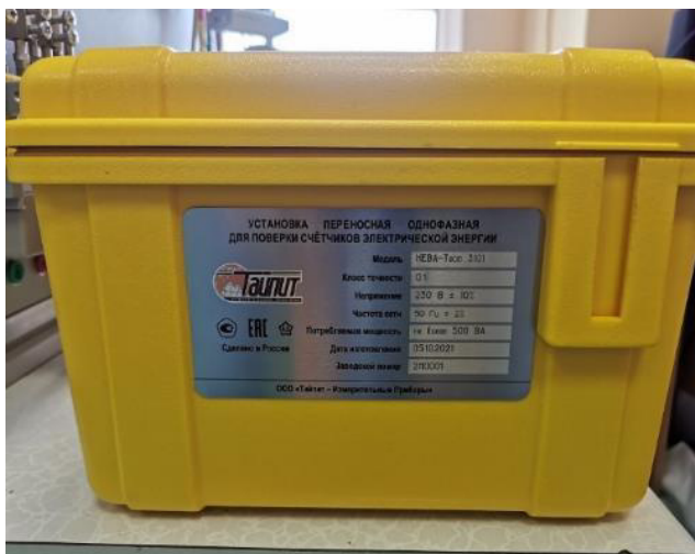
Рисунок 4 – Корпус установки переносной однофазной для поверки счетчиков электрической энергии НЕВА-Тест 3101, обозначение места нанесения заводского номера (2)
