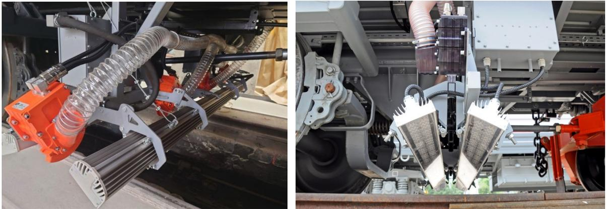
Рисунок 1 – Общий вид систем визуального обнаружения дефектов СВОД-2.
