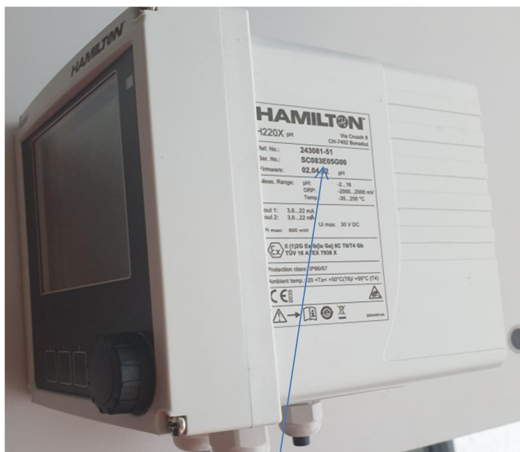
Рисунок 7 - Общий вид трансмиттеров H220x DO Memosens с указанием места нанесения заводского номера.
