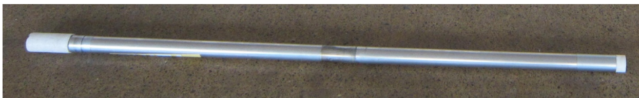
Рисунок 1 - Общий вид зонда иклинометрического CDS в сборе а) забойная часть; б) наземная часть (трансивер) - устройство приема-передачи информации CDS, в том числе для управления работой.
