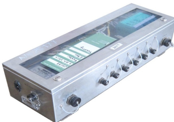
Рисунок 2 - Общий вид зондов иклинометрических CDST, IDS а) забойная часть CDST; б) забойная часть IDS; в) наземная часть (барьерный бокс)
