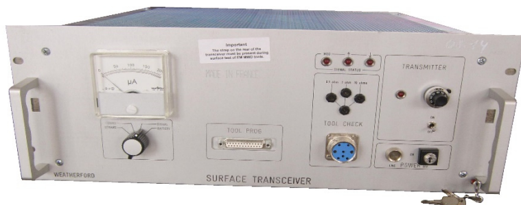
Рисунок 1 - Общий вид зонда иклинометрического CDS в сборе а) забойная часть; б) наземная часть (трансивер) - устройство приема-передачи информации CDS, в том числе для управления работой.
